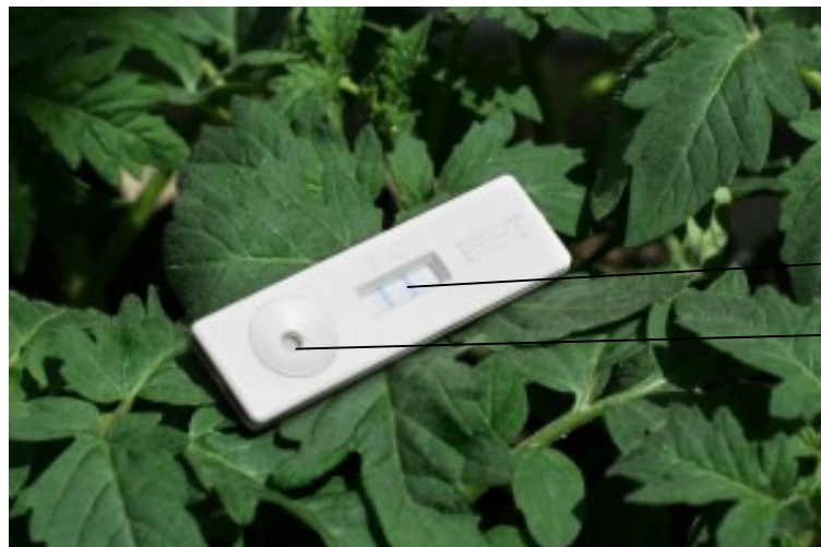
Figure 2 : Présentation de 'Lateral Flow Device' l'appareil de détection de la présence de Ralstonia solanacearum dans le plant de piment flétri.
