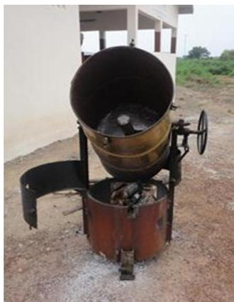
(ii) Tonneau basculant 80 kg
