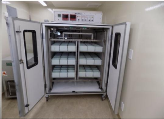
Photo 4 : L'intérieur de la couveuse (capacité 90 œufs)
